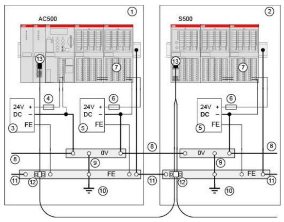
Fig. 12: AC500, equipotential bonding
